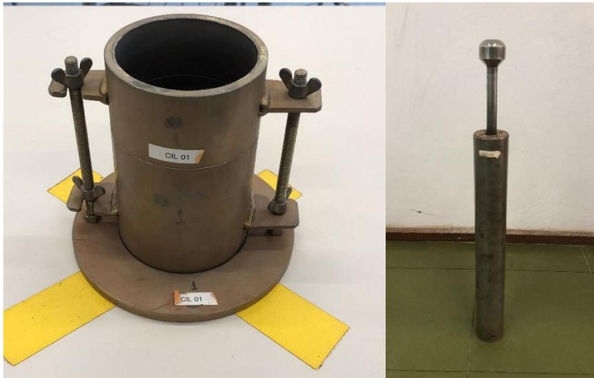
Figura 6: Cilindro e soquete de utilizados no ensaio de compactação
