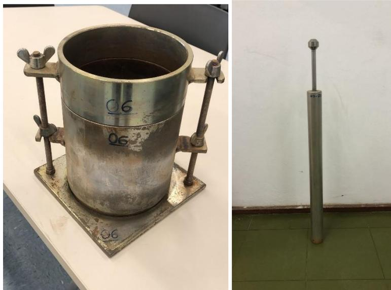
Figura 5 : Cilindro e soquete utilizados para o ensaio de CBR
