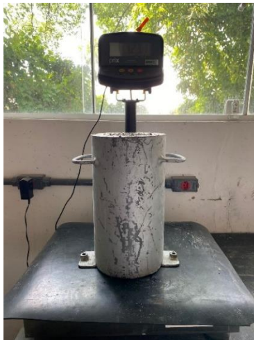
Figura 4 - Ensaio de massa unitária
