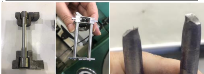
(a) Castanha: (b) Extensômetro: (c) Fratura Dúctil: CP antes do Ensaio. Detalhe Imagem do aço 303.
