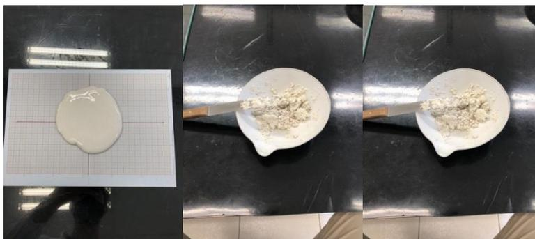
**Figura 7 - Resultados dos ensaios de mini slump, da esquerda para a direita: Gesso Comercial, Gesso Reciclado em Estufa e Gesso Reciclado em Autoclave Odontológica, respectivamente.**
