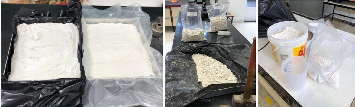
**Figura 2 – Da esquerda para a direita: pasta de gesso endurecida na forma, resíduo de gesso triturado com martelo e resíduo de gesso em pó após moagem, respectivamente.**
