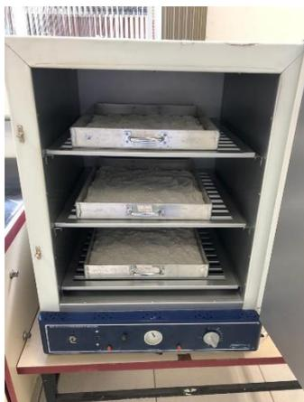
**Figura 5 – Preparação para a calcinação do gesso hidratado.**
