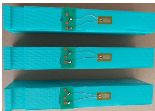
Figura 7 – Posicionamento dos strain gauges nas peças
