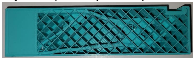
Figura 13 – Peça otimizada para 200 N impressa em PLA
