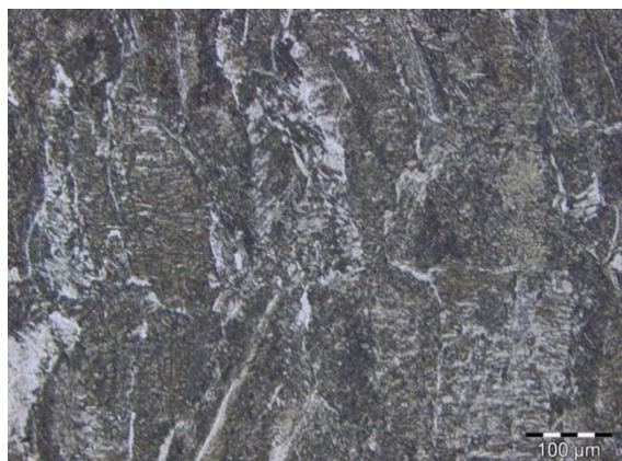
Figura 10 - Zona fundida (ponto de solda) 200x Nital
