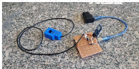
Figura 2 – Sensor SCT-013 associado ao Arduino
