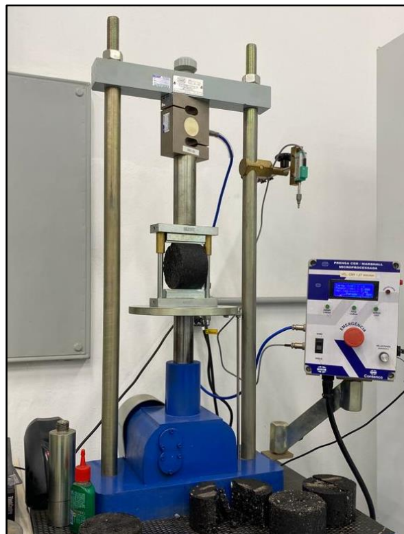
Figura 5 Prensa hidráulica para o ensaio de resistência à tração por compressão diametral
