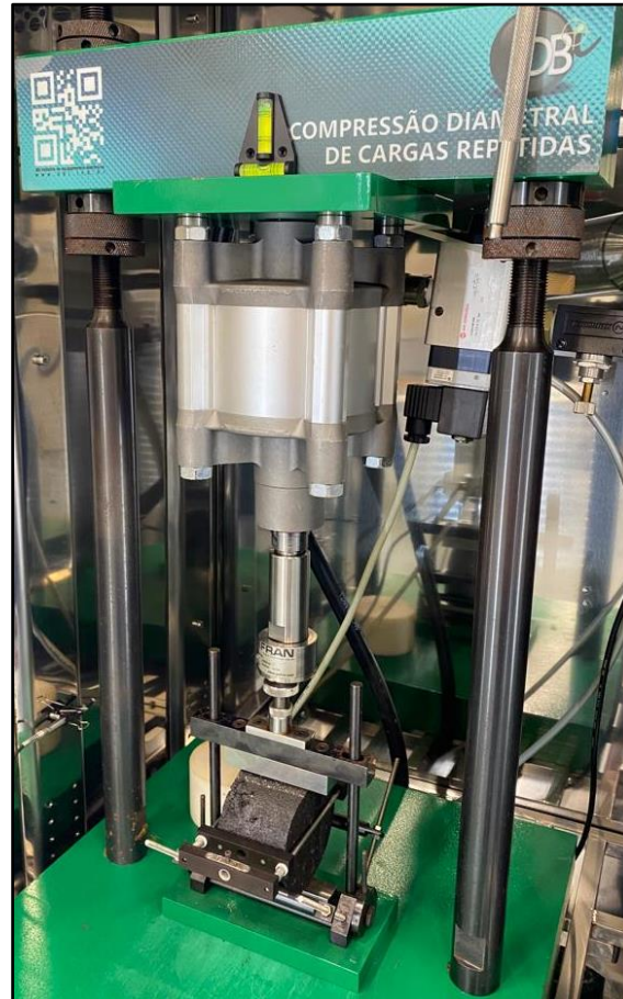
Figura 7 Modelo de montagem do ensaio triaxial de cargas repetidas
