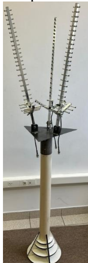
Figura 4 – Estrutura mecânica responsável por sustentar as três antenas de recepção.
