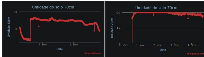
Figura 4– Gráficos padrões do ThingSpeak com exemplos de valores de umidade negativos
