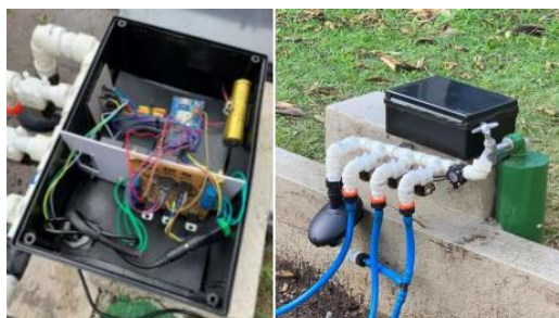
Figura 2– Circuito de controle da horta
