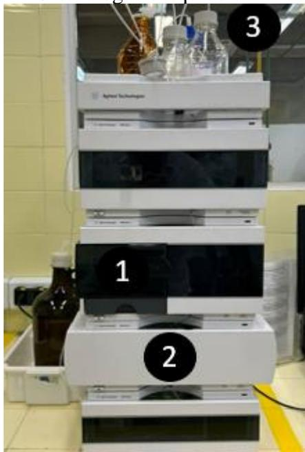
(1) Compartimento para amostras; (2) coluna; (3) frascos com soluções de limpeza e fase móvel
