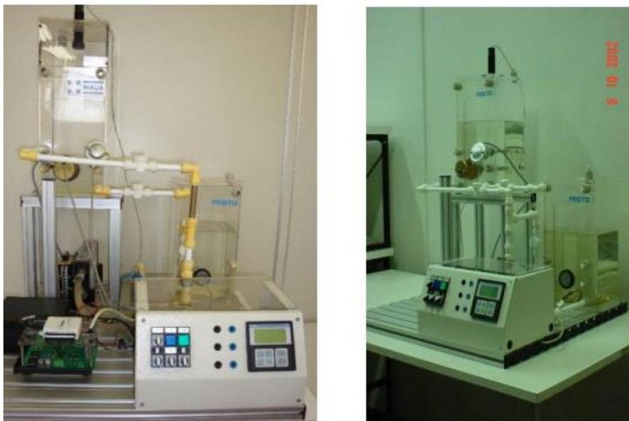
A bancada é composta por dois tanques por onde circula água destilada através de dutos e válvulas, sensores de nível, vazão e temperatura, dois atuadores que regulam a temperatura e o fluxo e uma unidade de controle onde é realizado o controle de todas as variáveis do sistema. Nessa aplicação o foco é apenas no controle de nível do tanque superior.
