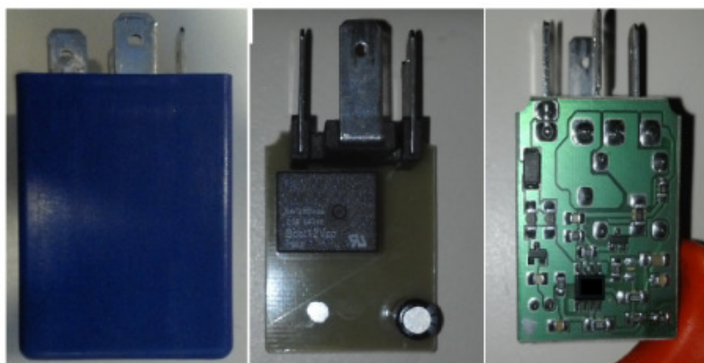
Figura 36 – Construção Interna do Relé.
