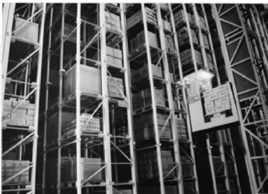
FIGURA 20. TRANSELEVADOR NA FÁBRICA DE MÁQUINAS DE LAVAR MIELE EM 1970.
