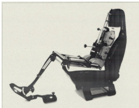
Figura 3: Dispositivo antropométrico construído de acordo com a norma SAE J4002
