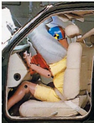
Figura 6 - Comportamento do manequim durante um ensaio real
