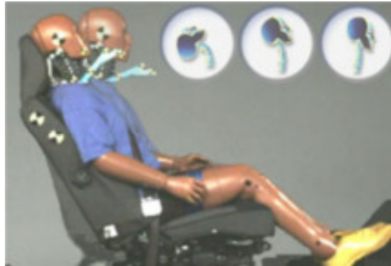
Figura 5 - Comportamento dinâmico previsto para o manequim durante um impacto
