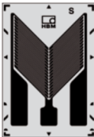
Figura 17: “ Strain Gauge ” para medição de torque
