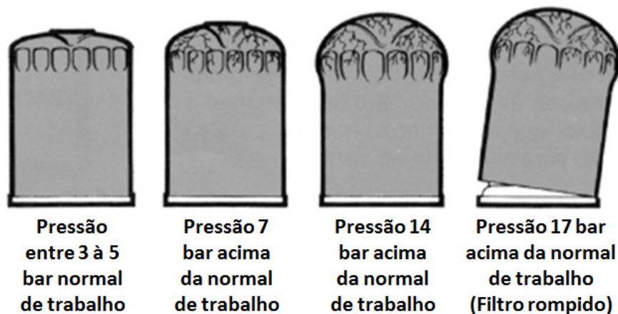
Fig. 32: Análise de resistência a pressão (hidrostático).
