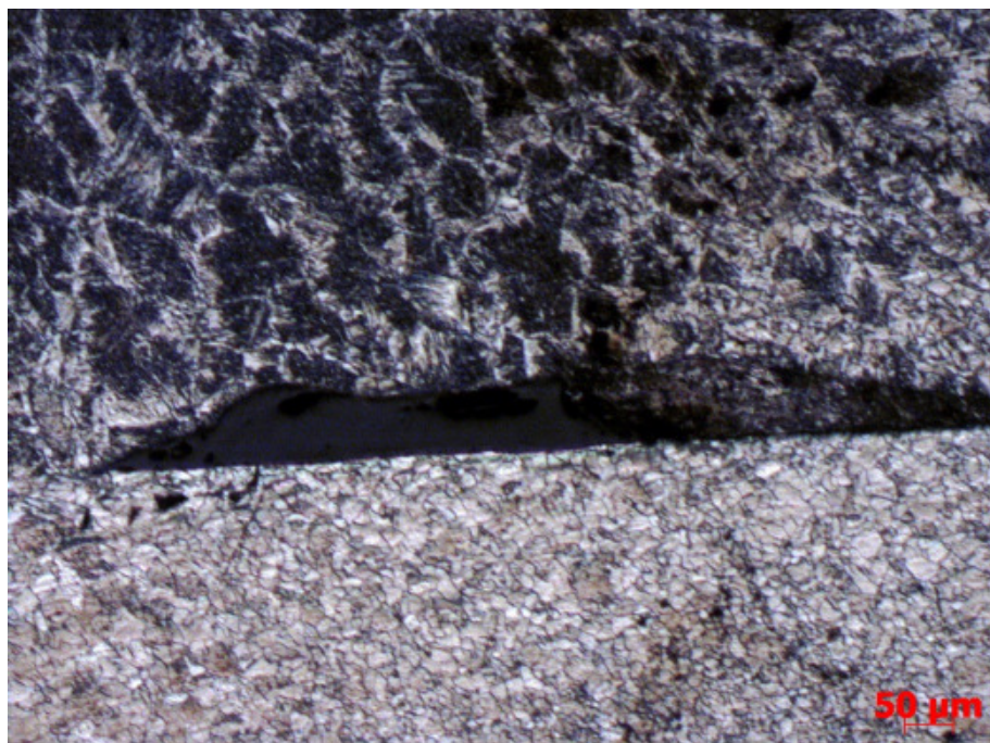
Figura 81 - CTA19 – Fronteira entre a ZF e a chapa 3 (abaixo), observa-se o início da fusão entre a ZF e chapa 1 à cima à esquerda.
