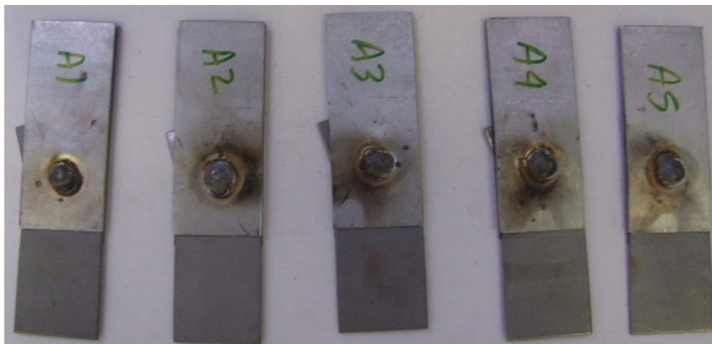
Figura 54 - Amostras de solda tampão na configuração A (simulando retrabalho) após teste de tração.
