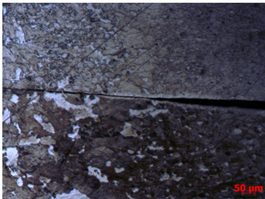
Figura 66 – Chapa 1 (superior) e chapa 3 (inferior), da esquerda para a direita observa-se o MB, claramente delimitado RS e a região IC.
