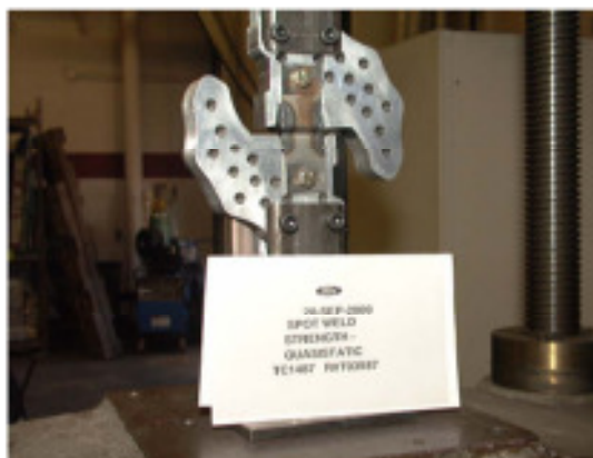
Figura 19 - Amostra sujeita a teste de tração pura segundo Madasamy et al. (2003).
