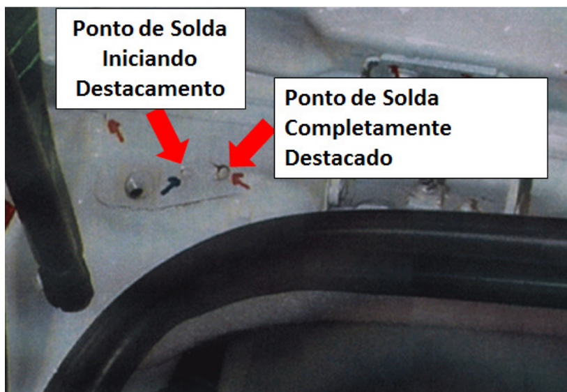
Figura 10 - Exemplo de trinca devido à falha por fadiga, tensão da região é significativamente menor que as de testes de tração segundo Kuo, Jayasuriya e Wung (2003).
