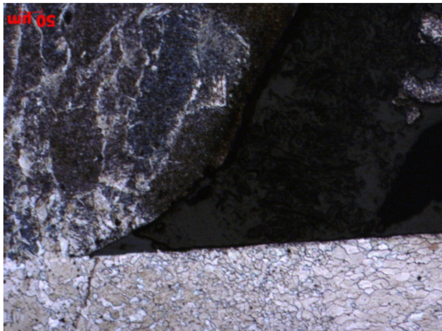
Figura 73 - CTA12 – À esquerda visualiza-se a junção entre a ZF e a ZAF da chapa 3.
