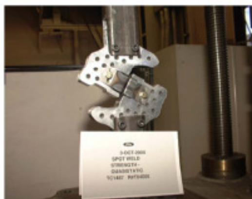
Figura 20 - Amostra sujeita a teste combinado de tração cisalhamento segundo Madasamy et al. (2003).
