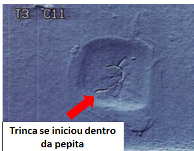
Figura 12 - Exemplo de trinca dentro da área do ponto de solda segundo Kuo, Jayasuriya e Wung (2003).
