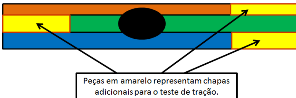
Figura 45 - Chapas adicionais de mesmo material e espessura (em amarelo), necessárias para realizar teste de tração.
