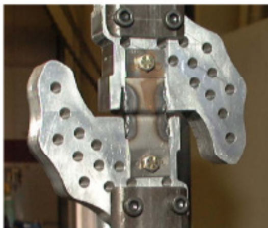
Figura 18 - Fixador adaptado para permitir a aplicação da carga em várias direções segundo Madasamy et al. (2003).
