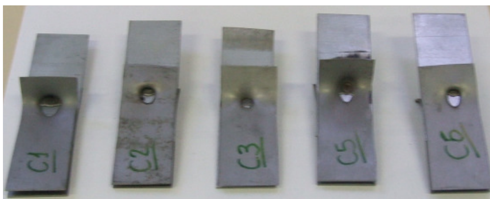
Figura 52 - Amostras de solda ponto na configuração C após teste de tração.
