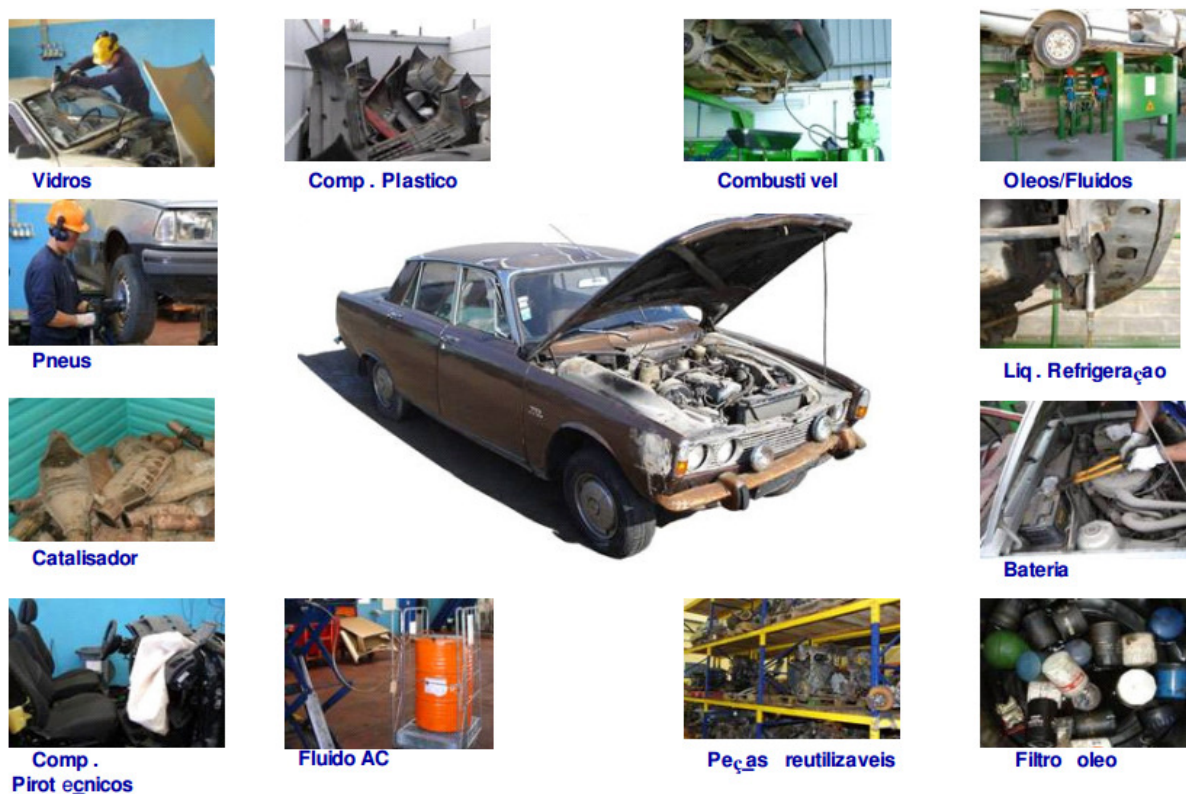
Figura 1.2: Exemplo de separação de peças para tratamento de reciclagem, FONTE: VALORCAR 2006
