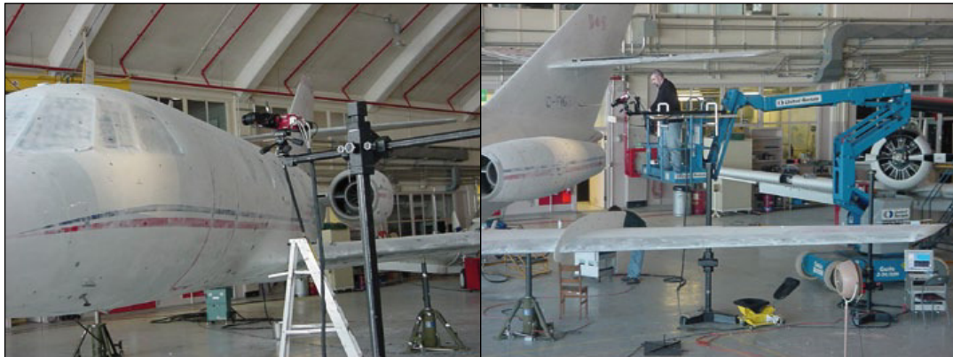
Figura 26 – Processo de Digitalização de um Avião Civil
