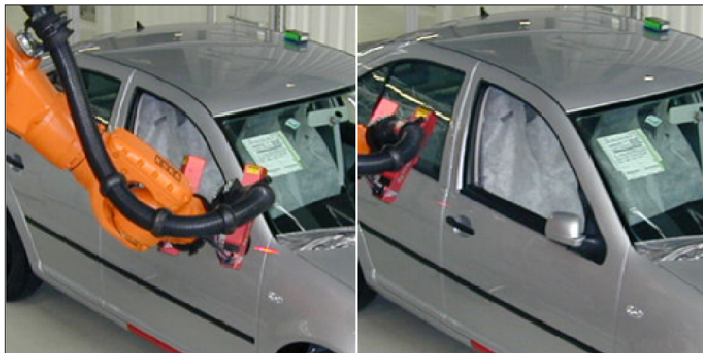
Figura 23 – Verificação Automatizada do Ajuste das Portas
