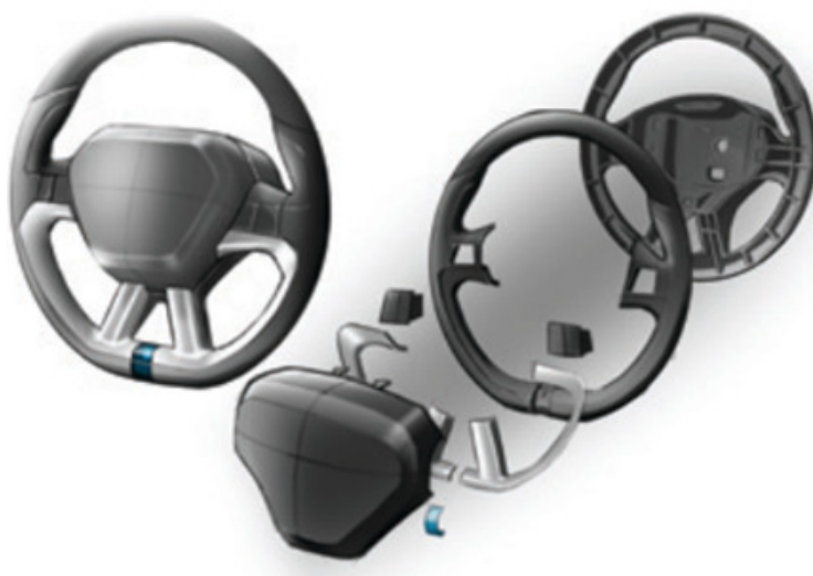
Figura 35 – Volante totalmente em plástico. Fonte: Sabic (2014)
