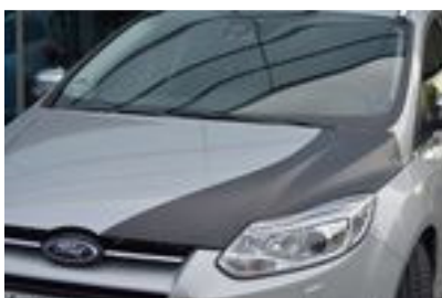
Figura 17 – Capô em plástico reforçado com fibra de carbono. Fonte: Green Car Congress (2014)
