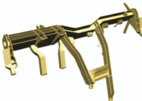
Figura 24 – Travessa em PP com fibra. Fonte: Chaturvedi, Schijve e Marks (2009)
