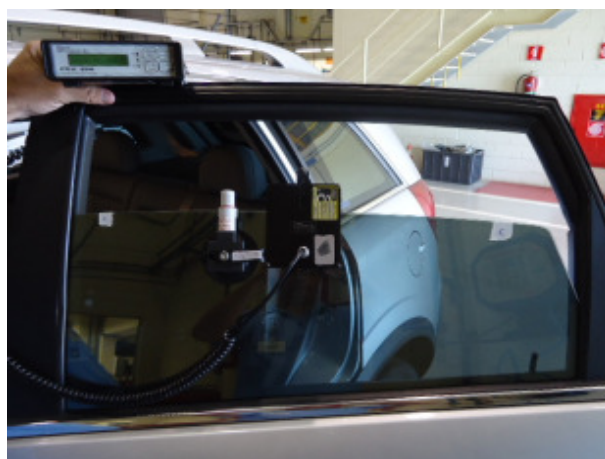
Figura 5 - Equipamento de medição montado em um vidro elétrico
