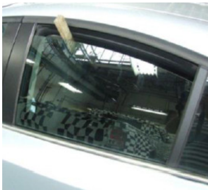
Figura 12 - Objeto esmagado por um acessório não homologado
