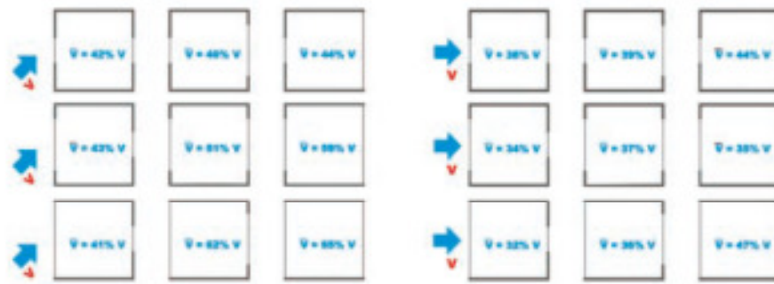
FIGURA 3.24 - Velocidades médias no interior de acordo com dimensões das aberturas de entrada e saída e incidências do vento a 45° e 90°.
