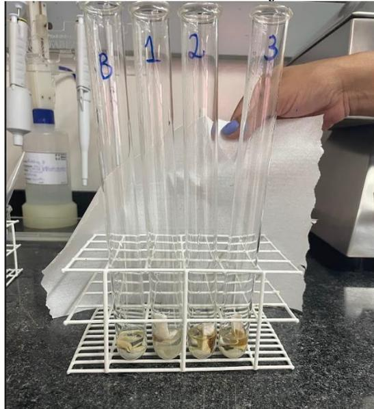
Após esse período, os tubos são submetidos a uma reação com hidróxido de sódio (NaOH) em um destilador, gerando um subproduto que será utilizado para medir a quantidade de nitrogênio presente, como a figura 3 apresenta.
