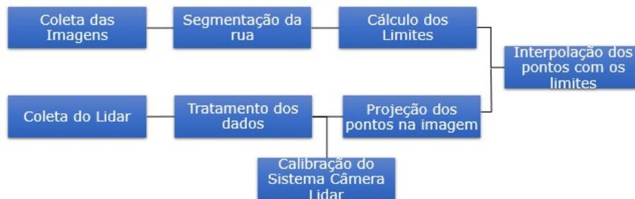
**Figura 7 - Fluxograma das etapas de cálculo do método que usa imagens e LiDAR.**
