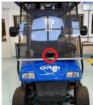
Figura 3 - LiDAR instalado na frente do ORBI
