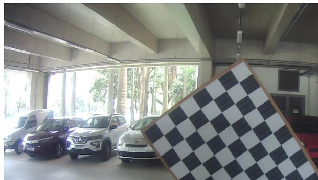
Figura 5 – Tabuleiro utilizado para a calibração do sistema câmera-LiDAR.
