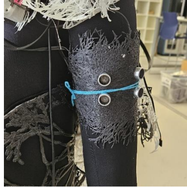
Figura 6 – sensores HC-SR04 aplicados em um braço do manequim vestindo o wearable
