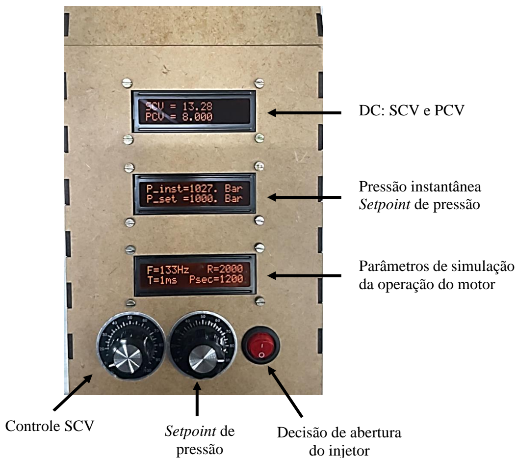
Figura 5 – Painel de controle.
