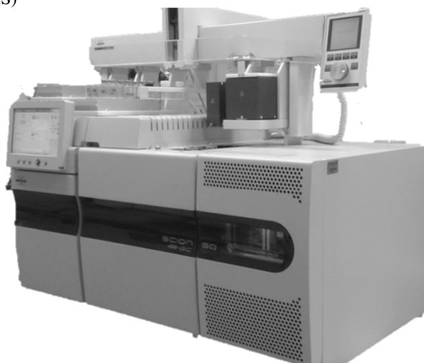
Figura 21– Cromatografia gasosa acoplada a espectrômetro de massa (GC-MS)
