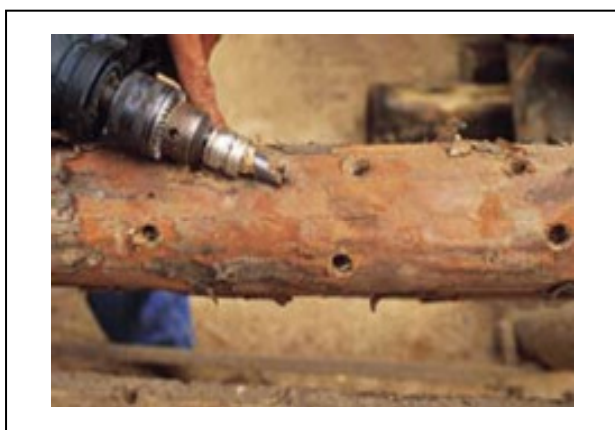
Figura 2. Exemplo de orifícios em tora de eucalipto realizados com a broca adequada.
