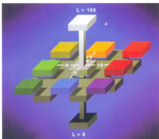
FIGURA 14 – Coordenadas de cor – Sistema CIELAB
