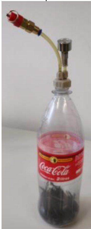
Figura 5- Válvula de alívio de pressão e manômetro na garrafa
