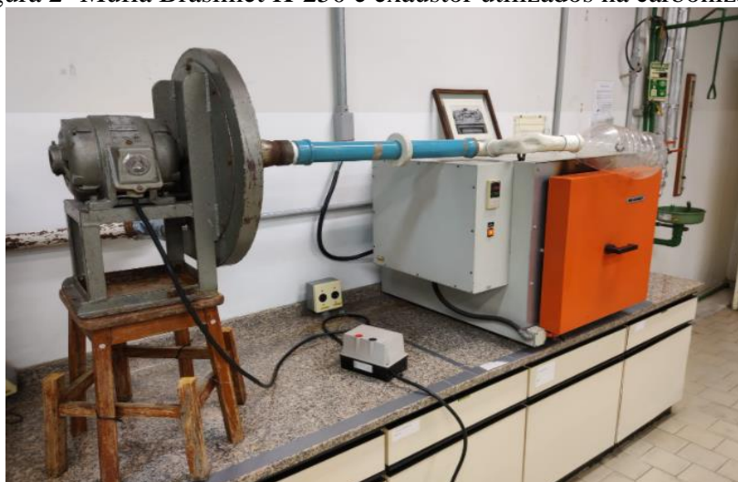
Figura 2- Mufla Brasimet K-250 e exaustor utilizados na carbonização
