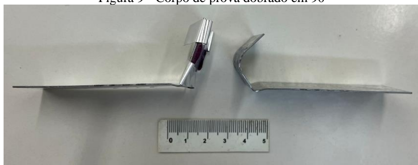
Figura 9 - Corpo de prova dobrado em 90°
