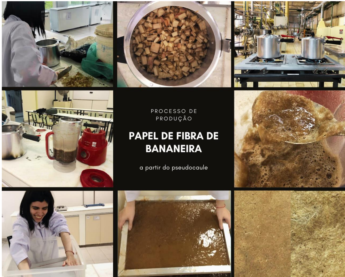
Figura 2 - Processo de produção de papel utilizando o pseudocaule da bananeira
