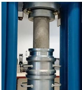
Figura 7: Teste do módulo de elasticidade do concreto
