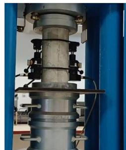
Seguindo o modelo apresentado obtém-se a resistência média à compressão ( $f_{cm}$ ) e seu módulo de elasticidade, sendo designado 6 corpos de prova para o módulo, sendo seu ensaio conforme a NBR 8522-1, onde o corpo de prova foi carregado com 30% da resistência à compressão e descarregado, novamente foi carregado até a tensão básica de 0,5 MPa, registrando as deformações durante o carregamento e descarregamento. Assim, os resultados são apresentados conforme a Tabela 2.
