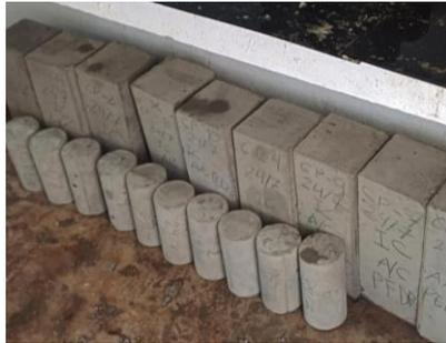
Após 28 dias de cura, foi selecionado 12 pilares, que seriam submetidos ao encamisamento pela CFRP, para ter seus cantos chanfrados, arredondados, (ACI 440.2R-17, 2017), têm-se como objetivo evitar a tensão de cisalhamento que seria acumulada nos extremos dos corpos de prova, inutilizando, assim, a manta. Assim, como mostrado na representação gráfica foi chanfrado os quatro cantos dos 12 pilares.
