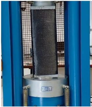
Figura 13: resultado visual após a ruptura do pilar pré-carregado e confinado
