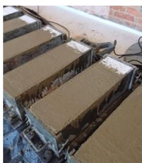
Após 2 dias, desmoldou-se os corpos de prova, para colocá-los na câmara úmida, a fim de que se faça a cura do concreto, sendo que nesses dois dias foi necessário umedecer a sua
