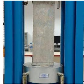
As duas imagens servem de exemplo para a execução dos demais pilares. Assim, estudou-se o uso da manta de fibra de carbono em diferentes níveis de deformação prévia do pilar.
