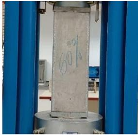
Figura 9: Ensaio de resistência à compressão do pilar prismático
