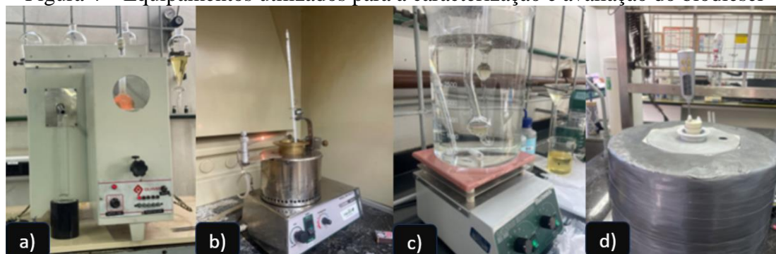
a) Destilador de solventes ASTM; b) Ponto de fulgor vaso aberto Cleveland; c) Banho viscosimétrico com viscosímetro tipo Cannon-Fenske; d) Ponto de fluidez
