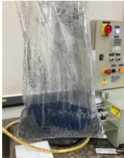
A figura 4 mostra diversas amostras de PEAD, depois de saírem do homogeneizador termo cinético e serem resfriadas a temperatura ambiente.
