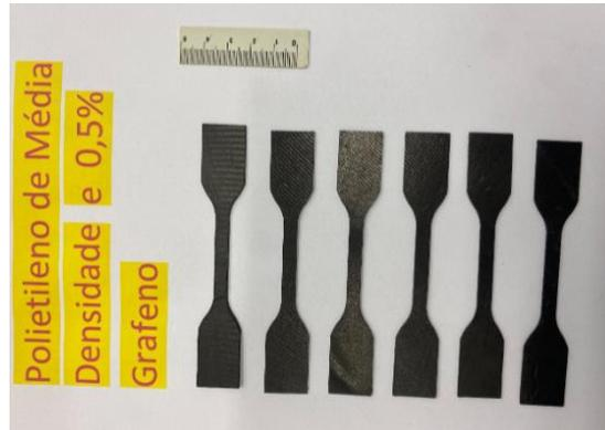
Agora com os corpos de prova prontos, é possível começar os testes de tração, é importante ser recordado que além dos testes das concentrações de 0,5%, de cada polietileno, foi necessário fazer um teste com o material puro, para efeitos comparativos.
