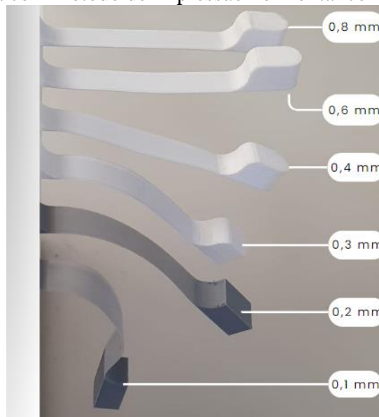
Figura 6 – peça de prova com método de impressão horizontal com até 0,1 mm de espessura
