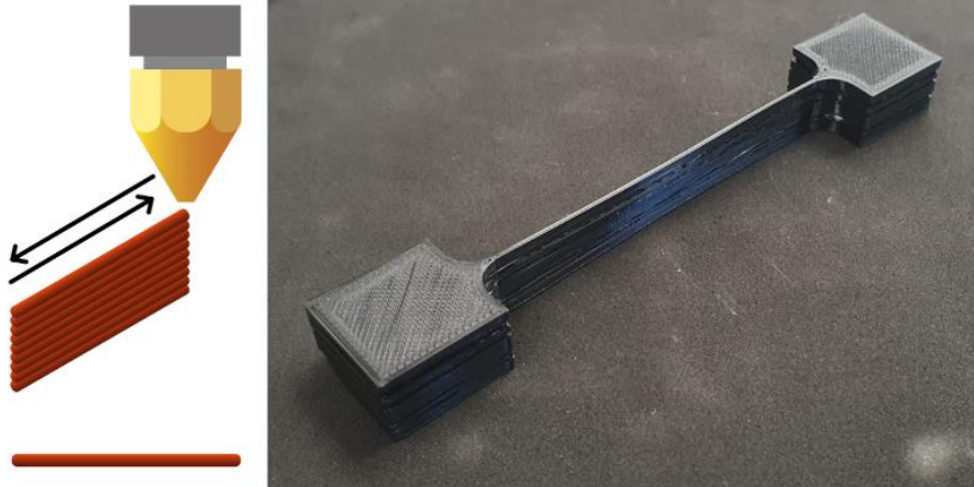
Figura 4 – peça de prova com método de impressão vertical (processo descartado)
