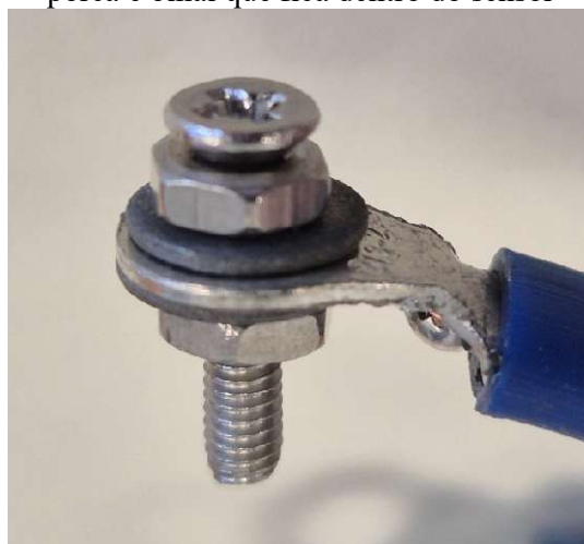
Figura 9 – Conexão mecânica de parafuso, porca e olhal que fica dentro do sensor
