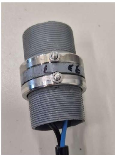
Figura 9 – Conexão mecânica de parafuso, porca e olhal que fica dentro do sensor
