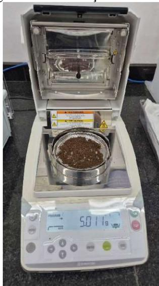
Foram coletadas três amostras diferentes de solo da área de cultivo e foi medida a umidade real utilizando a balança. Em seguida, as medições foram comparadas com as leituras fornecidas pelo sensor de umidade do solo, obtendo a reta de calibração (Figura 12) para garantir a precisão dos dados coletados. Essa calibração foi feita para cada nível do sensor, para garantir precisão.
