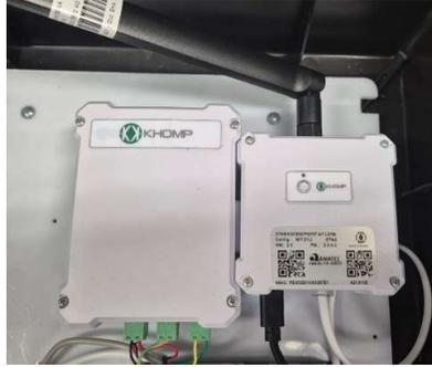
Todos os componentes da estação meteorológica foram integrados e acomodados dentro de uma caixa hermética, garantindo sua proteção contra as condições de campo. (Figura 6)
