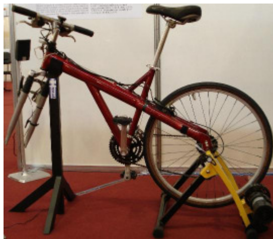
Figura 1 – Bicicleta do projeto com suporte de treino acoplado ao motor
