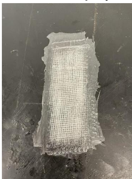
Figura 2 – Compósito do poliéster ortoftálico reforçado produzido para os fins experimentais.
