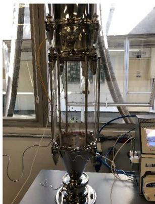
Antes do processo de secagem, o resíduo foi descongelado em temperatura ambiente por 1 h e prensado com auxílio de um pano descartável (Wypall, EUA) até extrair 30 % de líquido da massa inicial. 100 g do material prensado foi utilizado em cada experimento de secagem. Os parâmetros de secagem no leito fluidizado foram determinados por meio da curva fluidodinâmica e de ensaios
