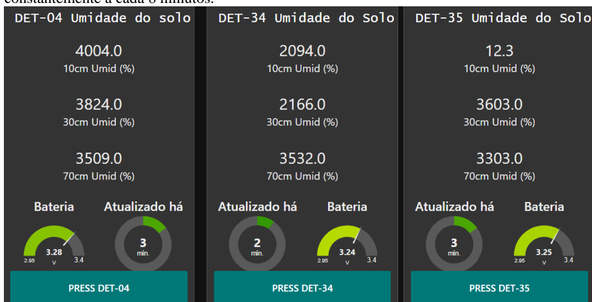
Figura 10 - Análise dos dados dos sensores de umidade no dashboard do smartcampus
