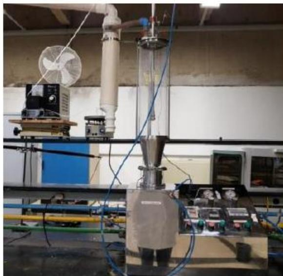
Figura 1- Leito fluidizado utilizada para a produção do *blend* de proteínas vegetais de ervilha e de arroz.
