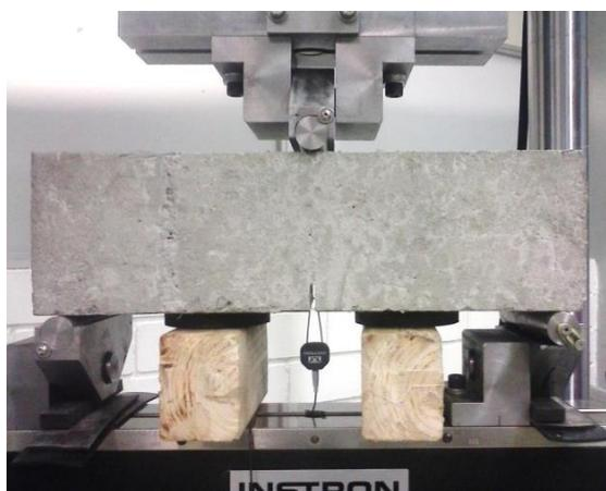
Figura 3 - configuração das vigas de flexão de três pontos ensaiadas de acordo com a EN 14651 (2005).
