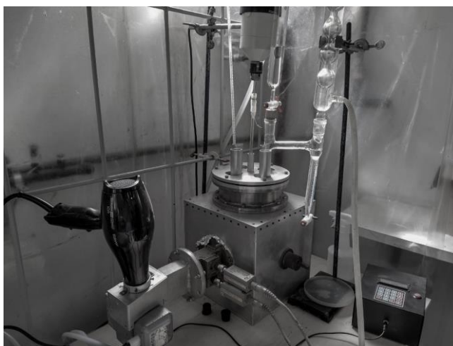
Figura 2 – Sistema de produção com micro-ondas.
