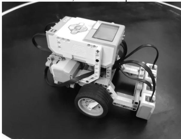
Figura 1 – Robô diferencial seguidor de linha com quatro sensores infravermelho e dois *encoders*.
