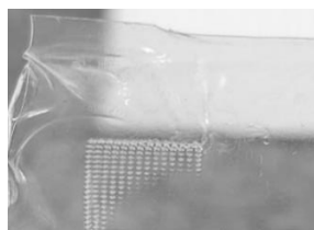
Figura 10 - Amostra 16 em condições de 3 toneladas, 30 minutos e 65 °C
