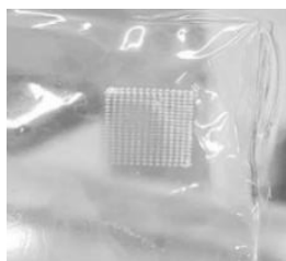
Figura 13 - Amostra 21 em condições de 3 toneladas, 90 minutos e 69-75 °C
