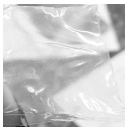
Figura 11 - Amostra 18 em condições de 6 toneladas, 15 minutos e 65 °C
