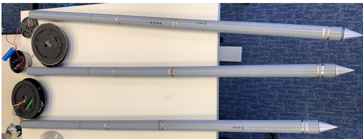
Figura 5 – Os três sensores montados com a eletrônica funcionando
