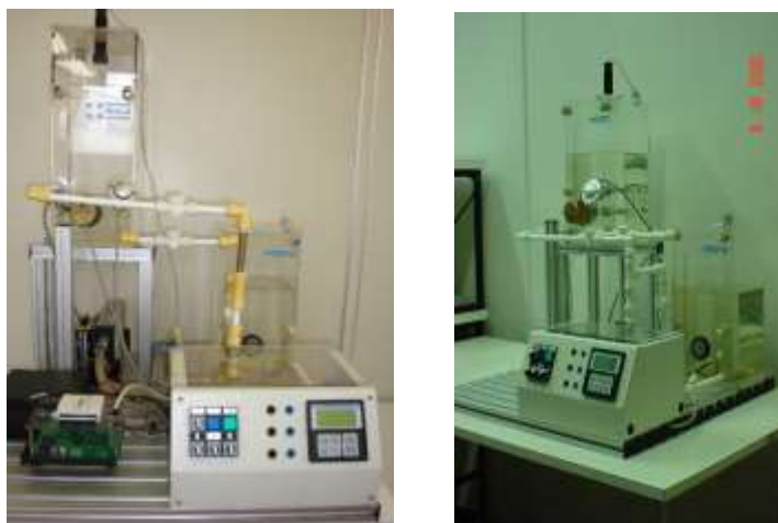
Figura 2 – Planta de controle de nível PCS Festo
