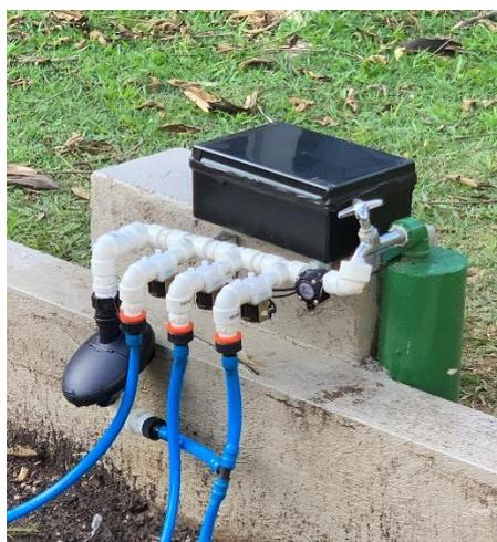
Figura 13 - Sistema automatizado de irrigação
